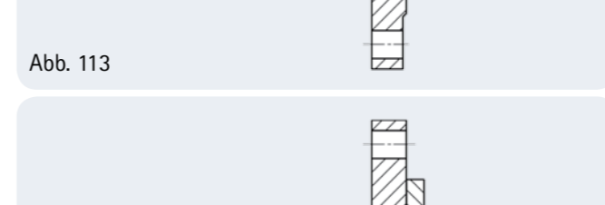
Abb. 114 Loser Flansch mit Bund nach EN 1092-1, z.B. wie hier abgebildet Typ 02
